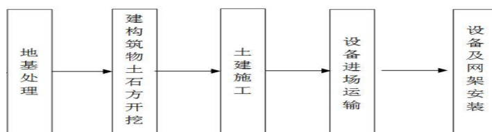
图 2-3 间隔扩建工程主要施工工艺和方法
