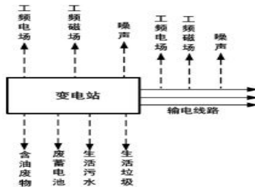
图 4-2 本工程运行期产污环节示意图
